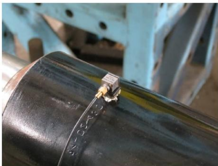
Fig. 3 Acceleratorul miniatural Bruel&Kjaer 4507B-005 montat pe sarcina utilă
