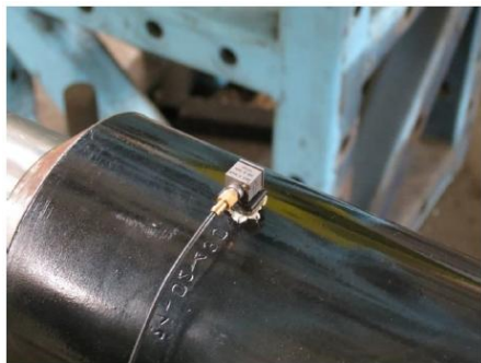
Fig. 3 The mini accelerator A Bruel&Kjaer 4507B-005 mounted on useful load
